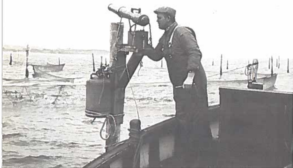
Fig. 21. Gaskanon monteret ved bundgarn i Ebeltoft Vig.
