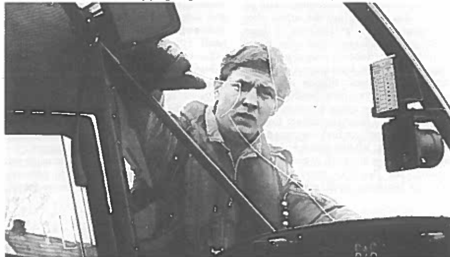
Kollision mellem et mindre fly og én gråand resulterede i en knust frontrude.
