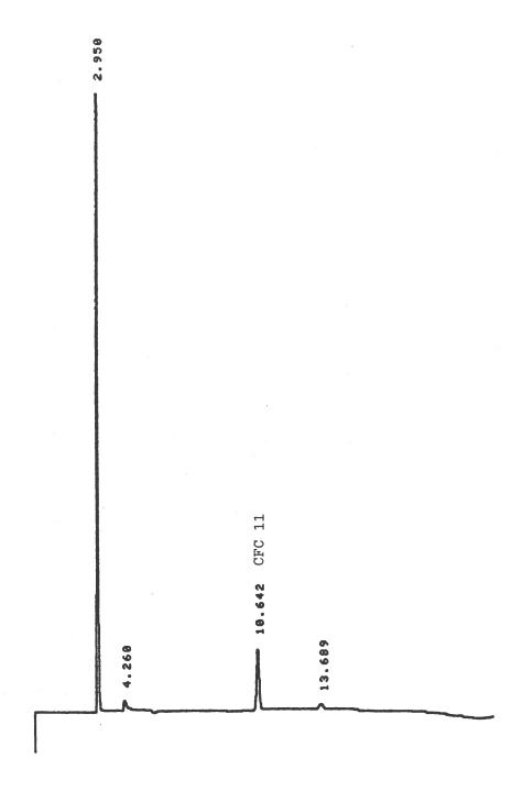
Figur 9: GC af standard CFC 11, 75 pg/0,5 ml gas, analyseret som XPS produkter. Arealtal af CFC 11 top = 13, 4 x  $10^3$
