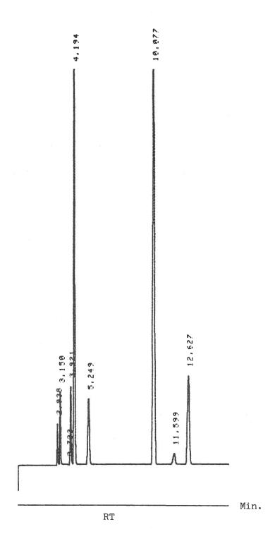
Figur 1: Retentionstider (RT) af standard CFC analyseret som aerosolprodukter. RT 2,938: CFC 13, RT 3,150: CFC 115, RT 3,921: CFC 1113, RT 4,194: CFC 12, RT 5,249: CFC 114, RT 10,077: CFC 11, Rt 12,627: CFC 113.
