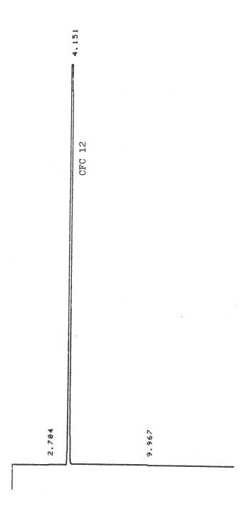
Figur 3: GC af standard aerosolbeholder indeholdende 1% CFC 12. Arealtal af CFC 12 top =  $20,3 \times 3 \times 10^6$
