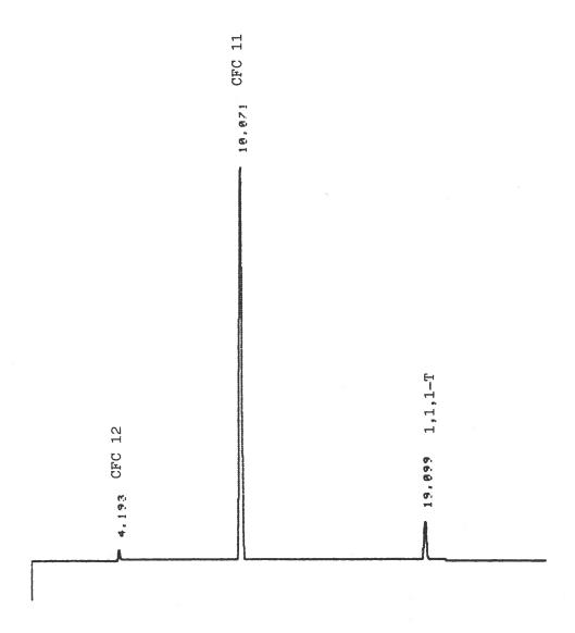
Figur 6: GC af prøve nr. 0-01105. Prøven indeholder spormængder CFC 11 og CFC 12.
