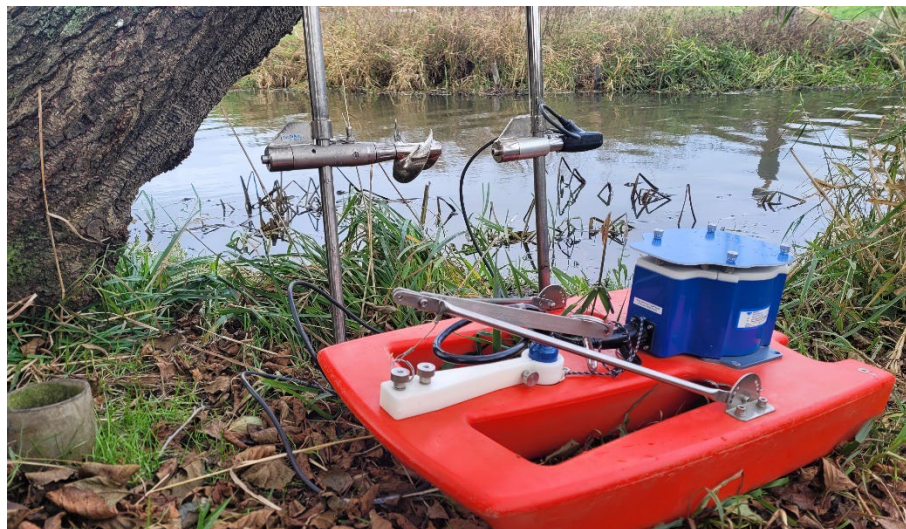
Figur 2.2 De 3 instrumenttyper der indgår i testen. Øverst til venstre: OTT C31 Universalflygel (Vingeinstrument), øverst til højre: Elektromagnetisk punkthastighedsmåler (OTT-MFPro), nederst: ADCP-StreamPro.
