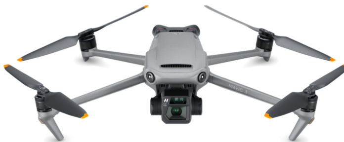
Figur 1. En DJI Mavic 3-drone med dobbelt Hasselblad kamera og zoom. Foto: DJI.
