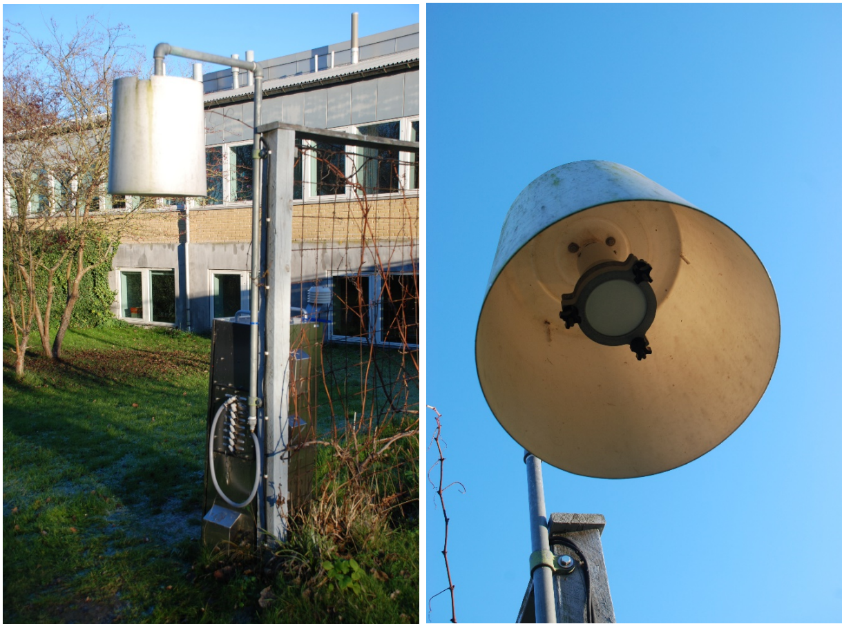
Figur 6.2. Udstyr til opsamling af pesticider i luft på Risø (Roskilde). Til venstre ses en filteropsamler, som anvendes til at suge med konstant luftflow gennem opsamlingsmaterialet. Samlet volumen er omkring 58 m 3 for en døgnopsamling. Opsamlingsmaterialet er placeret inde i den hvide afskærmning, som beskytter mod nedbør. Til højre ses holder til opsamlingsmaterialet (filter og PUF/XAD), der både opsamler pesticider på partikel- og gasfase. Efterfølgende ekstraheres hele prøven med ASE (Accelerated Solvent Extraction) og prøveekstraktet analyseres med gaskromatografi – dobbelt massespektrometri (GC-MS-MS).
