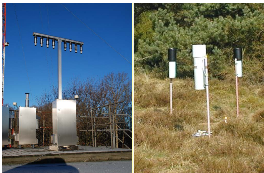
Figur 1.2. Eksempler på udstyr på målestationer. Til venstre: Filterpackopsamler til opsamling af luftprøver. Opsamleren består af en filterholder (for enden af hver af de otte arme) med tre filtre, som luften suges igennem, hvorved partikler og gasser opsamles og separeres. Til højre: Nedbørsopsamlere til bestemmelse af bulkdeposition (dvs. våddeposition plus et lille bidrag fra tørdeposition). Nedbørsopsamlerne består af et stativ, en tragt og en opsamlingsflaske monteret forinden på tragten. Opsamlingsflasken er placeret i rør for at beskytte mod sollys.
