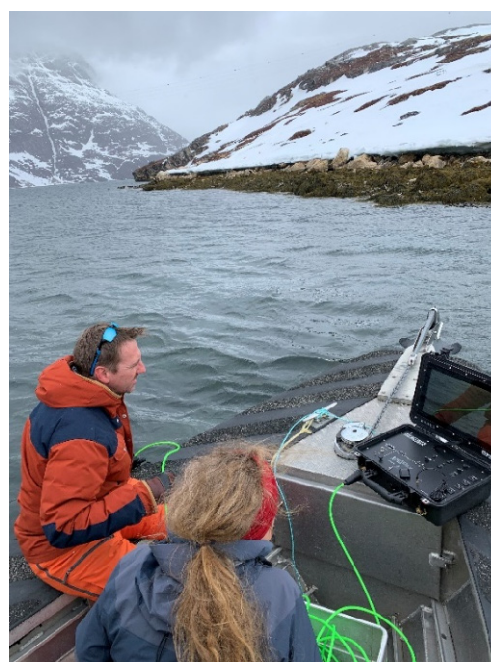
Figur 5. Undervandskameraet styres fra båden, mens videoen følges på skærm.
