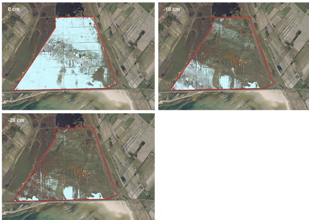
Figur 7.8. Illustration af modelleret vandudbredelse ud fra en højdemodel på Bygholmengen ved vandstande på henholdsvis 0 cm (øverst t.v.), -10 cm (øverst t.h.) og -20 cm (nederst).
