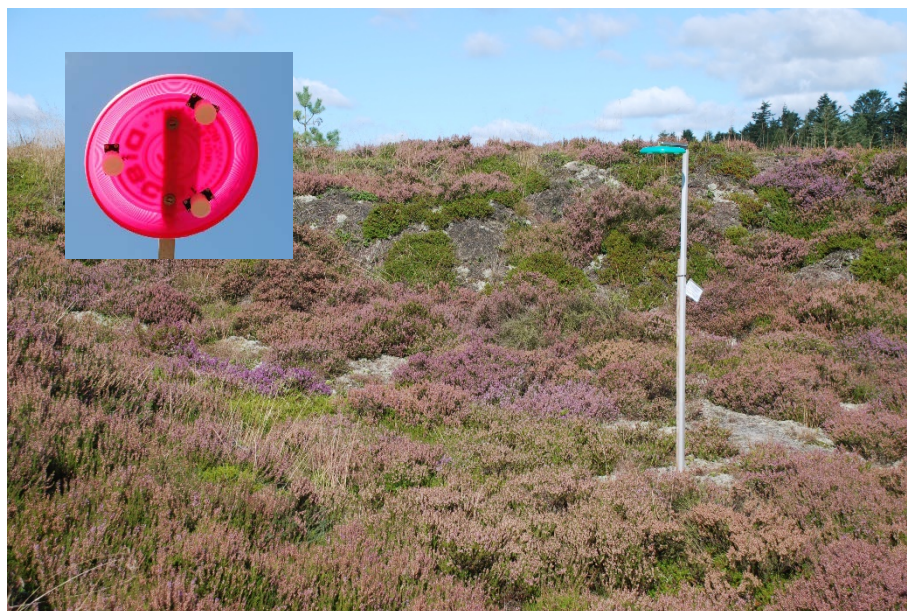
Figur 7.2. Udstyr til opsamling af ammoniak på Harrild Hede. Det indsatte billede viser undersiden af en afskærmning, hvorunder de tre passive opsamlere til opsamling af luftens indhold af ammoniak er monteret. De passive opsamlere indeholder et imprægneret filter, som binder ammoniak. Efter opsamlingen analyseres filtrets indhold af ammoniak ved hjælp af en spektrofotometrisk metode i laboratoriet. Afskærmningen beskytter de tre opsamlere mod nedbør.
