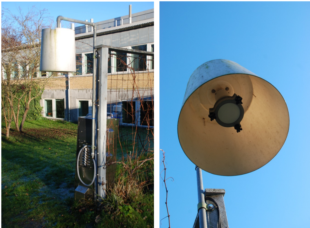
Figur 6.6. Udstyr til opsamling af pesticider i luft på Risø (Roskilde). Til venstre ses en filteropsamler, som anvendes til at suge et konstant luftflow gennem opsamlingsmaterialet. Samlet volumen er omkring 58 \text{ m}^3 for en døgnopsamling. Opsamlingsmaterialet er placeret inde i den hvide afskærmning, som beskytter mod nedbør. Til højre ses holder til opsamlingsmaterialet (filter og PUF/XAD), der både opsamler pesticider på partikel- og gasfase. Efterfølgende ekstraheres hele prøven med ASE (Accelerated Solvent Extraction) og prøveekstraktet analyseres med gaskromatografi – dobbelt massespektrometri (GC-MS-MS).
