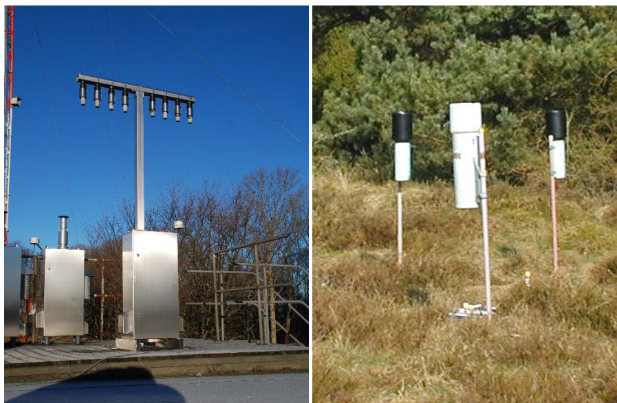
Figur 1.2. Eksempler på udstyr på målestationerne. Til venstre: Filterpackopsamler til opsamling af luftprøver. Opsamleren består af en filterholder (for enden af hver af de otte arme) med tre filtre, som luften suges igennem, hvorved partikler og gasser opsamles og separeres. Til højre: Nedbørsopsamlere til bestemmelse af bulkdeposition (dvs. våddeposition plus et lille bidrag fra tørdeposition). Nedbørsopsamlerne består af et stativ, en tragt og en opsamlingsflaske monteret forinden på tragten. Opsamlingsflasken er placeret i rør for at beskytte mod sollys.
