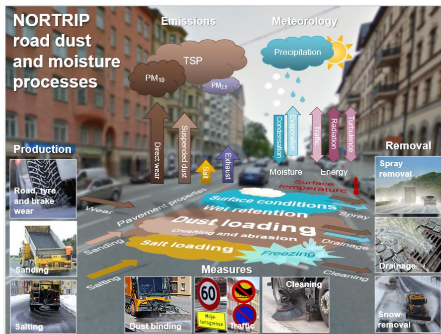
Figur 11.1. NORTRIP modellen, skematisk illustration af processer, som er behandlet i NORTRIP modellen (Figur fra Denby 2013a og Kupiainen et al. 2017).
