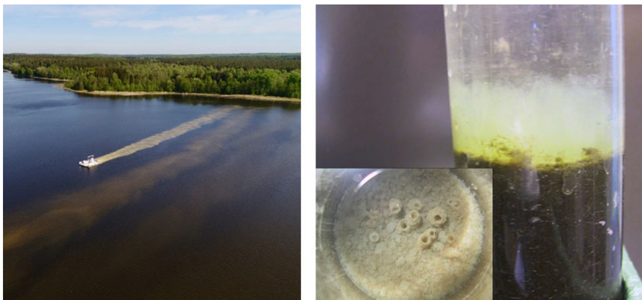
Figur 4.1. Venstre: Behandling med Phoslock (foto gengivet med tilladelse fra Phoslock Europe GmbH). Højre: Behandling med aluminium, der har lagt sig som snefnuglignende flokke på overfladen af sedimentet.
