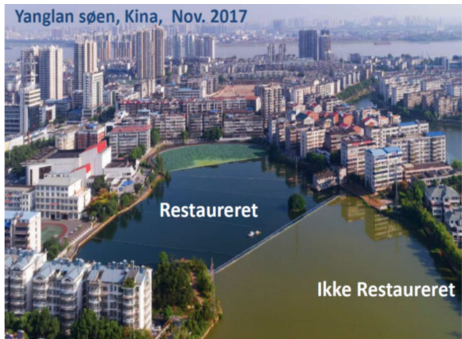
Figur 8.2. Eksempel på effekter af restaurering af en del af Yanglan-søen i Kina sammenlignet med en ikke restaureret del af søen. Ved restaureringen blev der først foretaget en opfiskning, efterfulgt af kemisk behandling af sedimentet med Phoslock og endelig udplantning af undervandsplanter – alt sammen gennemført i perioden juli til oktober 2017 (Hu He og Zhengwen Liu, NIGLAS, Nanjing). Fotoet er fra november 2017.
