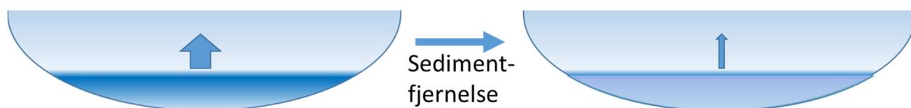
Figur 3.29. Konceptet bag sedimentfjernelse i søer, hvor der er ophobet en stor pulje af mobilt fosfor. Pilens tykkelse illustrerer omfanget af nettofosforfrigivelse fra søbunden om sommeren.
