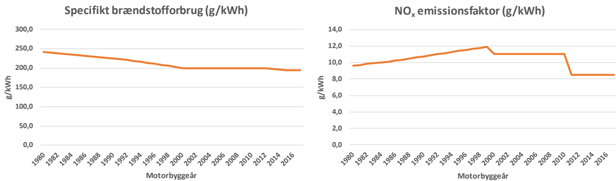
Figur 4.3. Specifikke brændstofforbrug og NO x emissionsfaktorer som funktion af motorbyggeår for medium speed skibsmotorer anvendt for krydstogtskibene i undersøgelsen.
