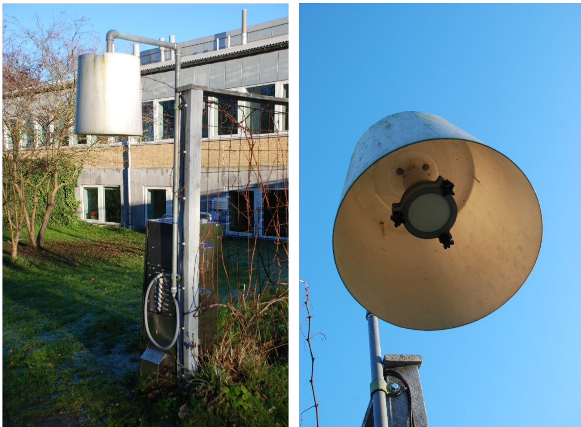
Figur 6.6. Udstyr til opsamling af pesticider i luft på Risø (Roskilde). Til venstre ses Low volume samplern, som anvendes til at suge et konstant luftflow gennem opsamlingsmaterialet, som er placeret inde i den hvide spand, som beskytter mod nedbør. Til højre ses (nedefra) holder til opsamlingsmaterialet (filter og PUF/XAD) der både opsamler pesticider på partikel- og gasfase.
