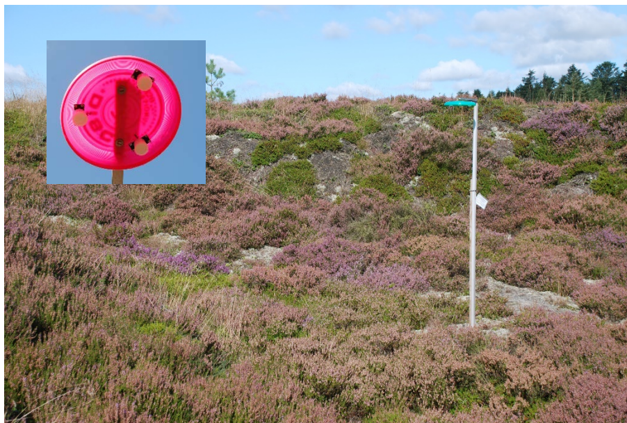
Figur 7.2. Udstyr til opsamling af ammoniak på Harrild Hede. Det indsatte billede viser undersiden af en afskærmning, hvorunder de tre passive opsamlere til opsamling af luftens indhold af ammoniak er monteret. De passive opsamlere indeholder et imprægneret filter, som binder ammoniak. Efter opsamlingen analyseres filtrets indhold af ammoniak ved hjælp af automatisk spektrofotometrisk metode. Afskærmningen beskytter de tre opsamlere mod nedbør.
