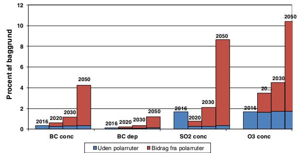
Figur DS 6 Stigning i BC deposition og BC, SO<sub>2</sub> og O<sub>3</sub> overfladekoncentrationer for skibstrafik i 2016 (ensartet gitterfordelt), 2020, 2030 og 2050 (hele året og sommerperioden), beregnet som procentdele af baggrund.
