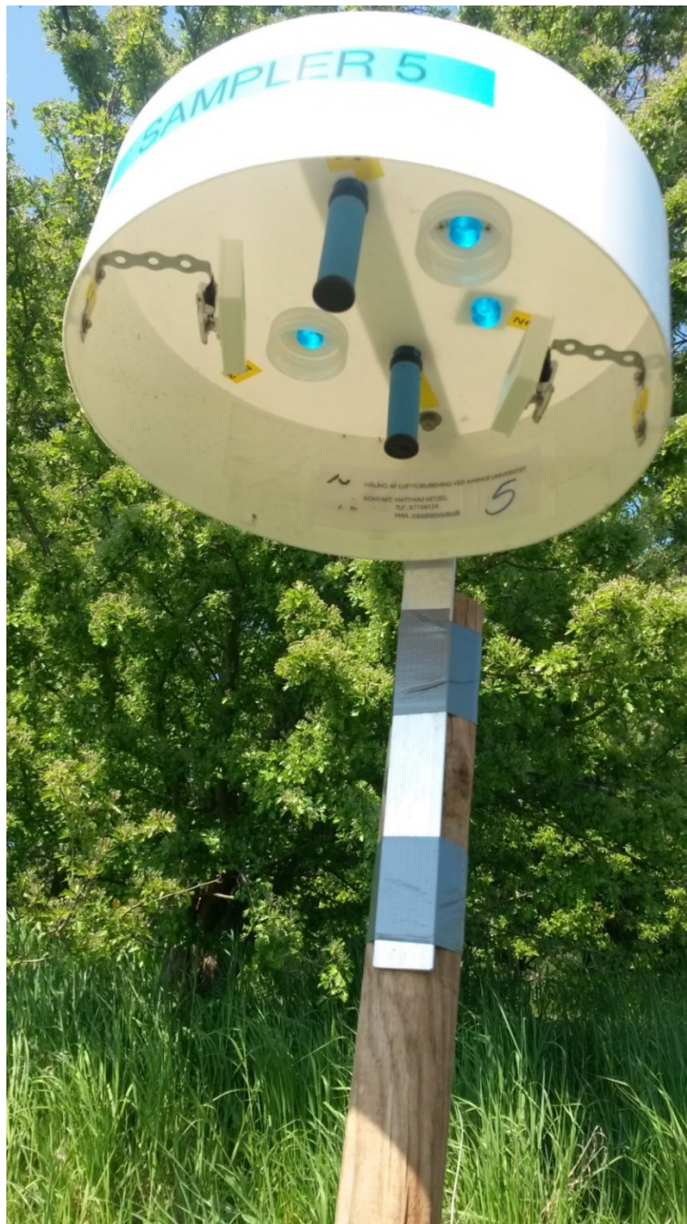
Figur 5.2. Advantec \text{NO}_2 -opsamlere (hvid badge med klemme) placeres beskyttet af afskåret plastikspand (øvrigt anordninger kan bruges til andre typer af måleudstyr). Måle-højden er 1,5 m.
