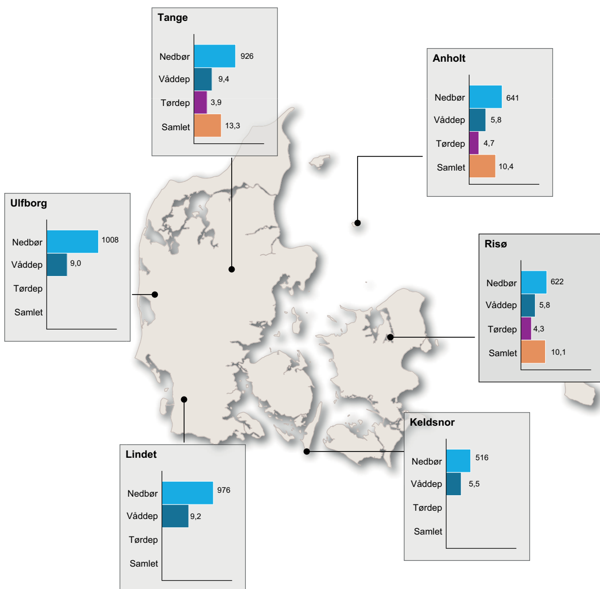
Figur 2.3. Kvælstofdeposition (kg N/ha) og nedbørsmængde (mm) ved målestationerne i 2014. Figuren angiver deposition til den gennemsnitlige landoverflade omkring målestationerne (Ellermann et al. 2015).
