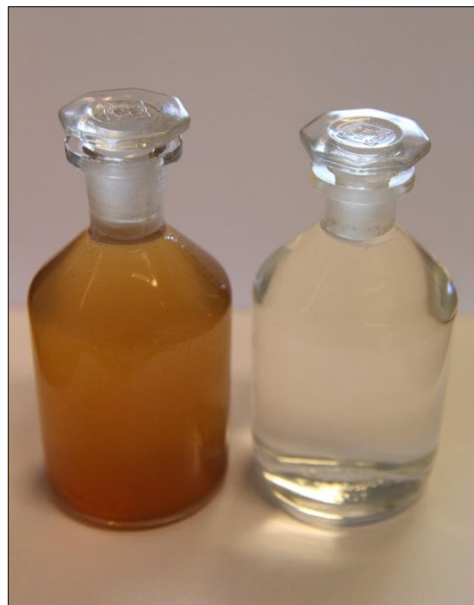
Winkler-prøver med ilt (brune) og uden ilt (klare) efter tilsætning af reagenser – analysemetode udviklet i slutningen af 1800-tallet til bestemmelse af vands indhold af ilt. Foto: Jens Würgler Hansen.
