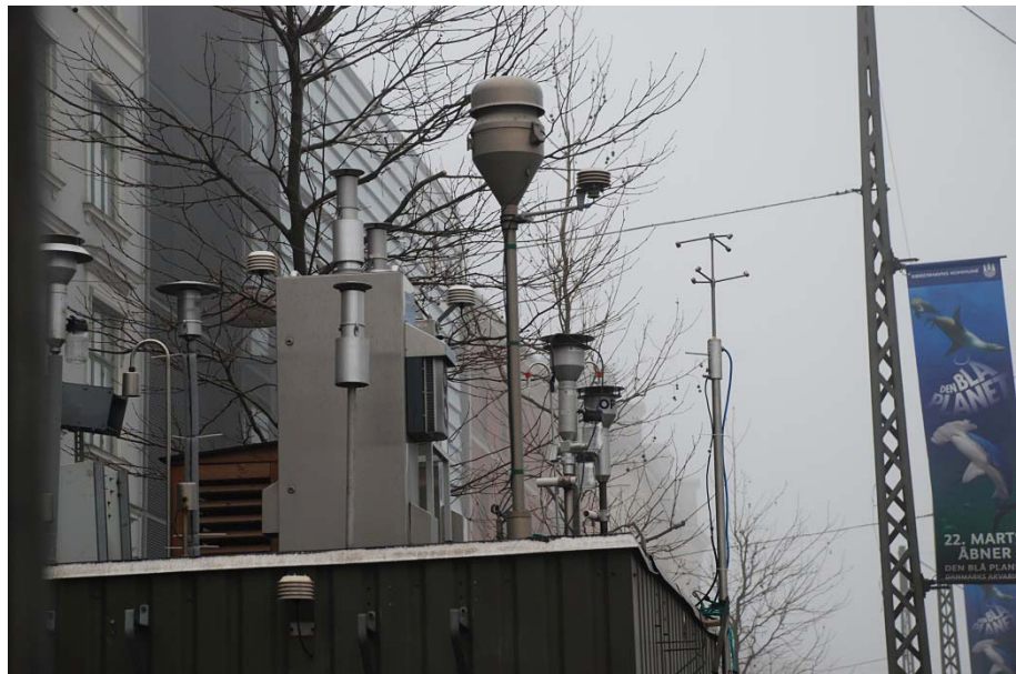
Figur 5.1. Sonic anemometer (instrument yderst til højre) oven på målestationen på HCAB.
