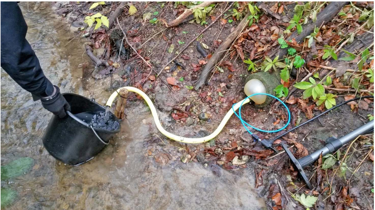
Figur 31. Måling med delvis afspærring med oppustelig ventil (elefant) og opsamling via slange i beholder. Drænudløb: 150 mm betonrør.
