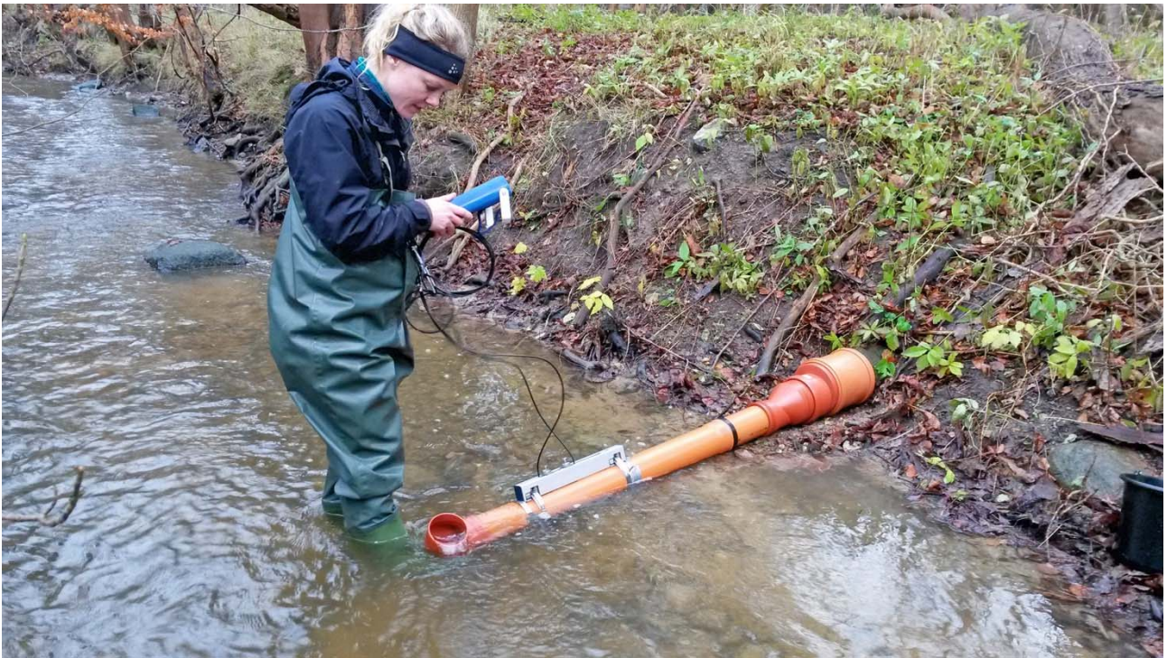
Figur 30. Måling med ultralyds-Doppler, clamp-on flowmåler monteret på 110 mm rør. Drænudløb: 200 mm betonrør.
