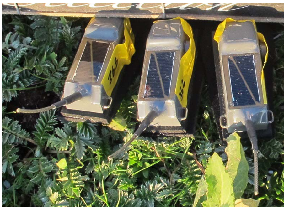
Figur 1. GPS/GSM-sendere klar til montering på gæs. Senderne er på undersiden forsynet med en neopren-plade, som skal modvirke, at senderne generer fuglene.
