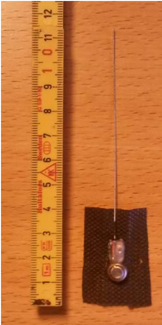
Figur 4. VHF-tag til montering på harekilling
