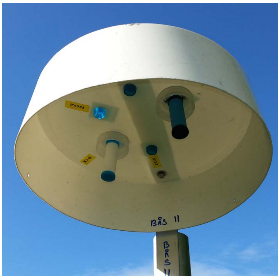
Figur 3.3. Eksempel på opsamling af kvælstofdioxid med passiv opsamling. Den hvide "spand" beskytter mod nedbør. Den blå og hvide "pind" under spanden er de passive opsamlere, som binder kvælstofdioxid kemisk på et filter inde i opsamlere. Efter endt opsamlingsperiode samles de passive opsamlere ind og indholdet af kvælstofdioxid analyseres i laboratoriet.
