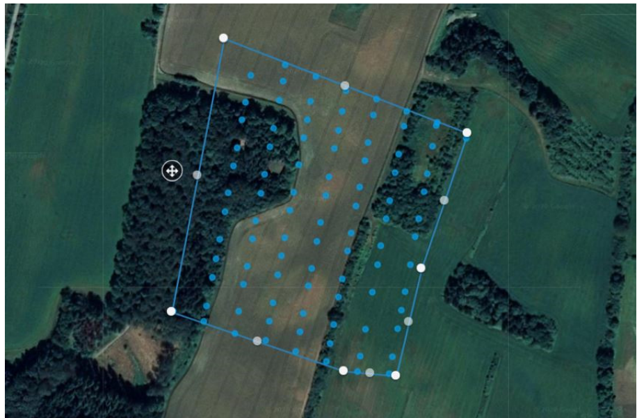
Figur 3.3. Punkter der viser dronens position ved hvert billede taget under transektflyvningen.
