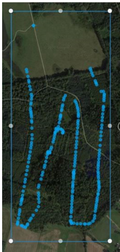
Figur 3.1. Forsøg på dækning af skovområde ved manuel flyvning. Billedet til venstre viser positionen for hvert billede der blev taget under kortlægningen. Til højre er billederne sat sammen og afslører områder der ikke er blevet dækket. Bemærk at DroneDeploy ikke har kunne sætte alle billederne sammen og der derfor mangler nogle områder på højre billede.
