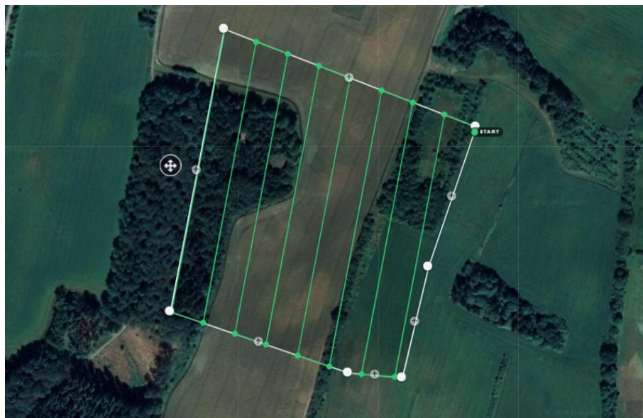
Figur 3.2. Transekter udlagt af programmet DroneDeploy. Det valgte område er på 10 ha og tog 6 minutter at overvåge i 100m højde og med 30% overlap mellem billederne. Flyvehastigheden var 12 m/s
