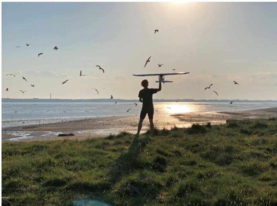
Figur 3.1.1.6. Den benyttede E384 fastvingedrone kan ikke selv lette fra jorden, men kommer i luften ved at man kaster den afsted, hvorefter den langsomt stiger til den ønskede flyvehøjde. Foto: Thomas Eske Holm.
