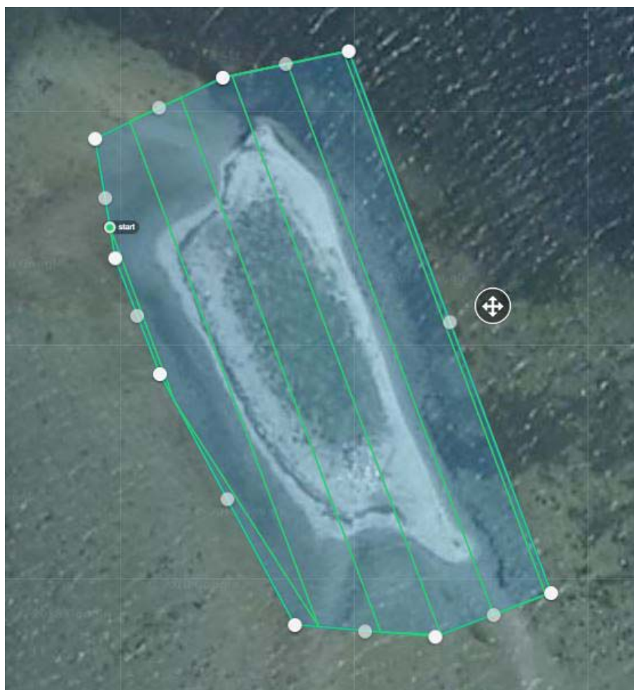
Figur 5.1. Området der ønskes kortlagt indtegnet med DroneDeploy. Den ønskede flyvehøjde og det procentvise overlap på billederne bestemmer antallet af transekter der skal flyves. Foto: Screenshot fra DroneDeploy
