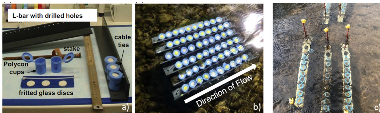
Figur 1. Agarkopper, glasfiltre og opstilling i feltet; a) og b) efter Tank et al. (2017); c) fra vores feltforsøg.
