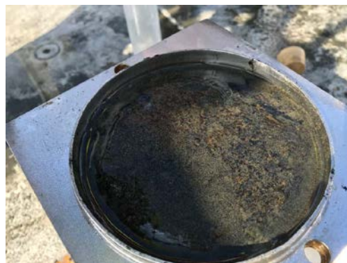
Hapsprøve af sediment der er påvirket af iltsvind. Reduceret jern i form af sort jernsulfid (FeS) er synligt i overfladen af sedimentet. Foto: Signe Høgslund.
