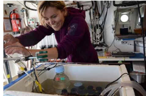
Måling af iltforbrug i sediment og vandsøjle i vådlaboratoriet ombord på Aarhus Universitets forskningsskib AURORA. Foto: Kitte Linding Gerlich.
