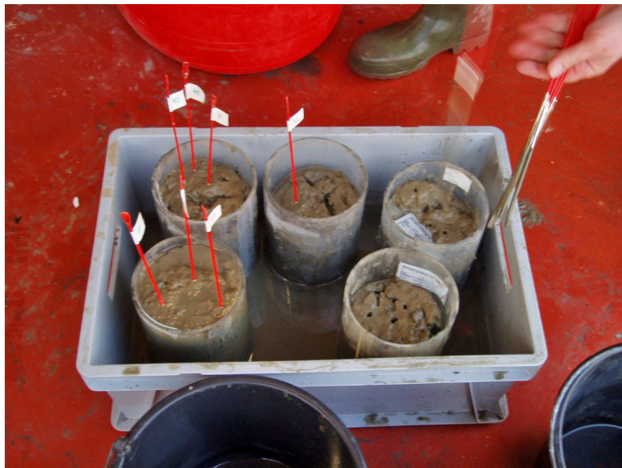
Figur 5.2.1. Måling af svovlbrinte-front i hapskerner med sølvstænger i Kattegat 2007. Målingen sker forud for sigtningen af sedimentet og efterfølgende undersøgelse af bundfaunaen.
